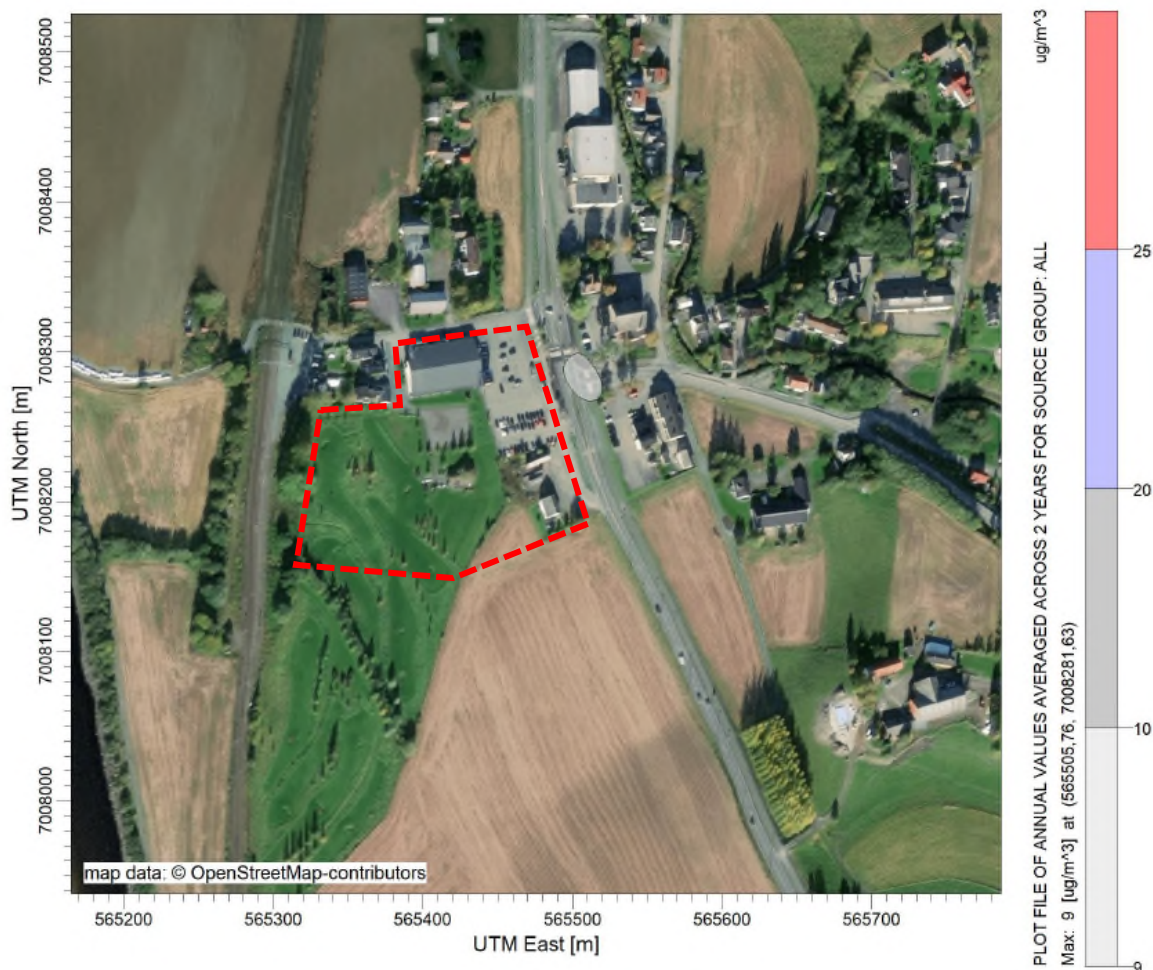
Figur 8: Luftsonekart som viser årsmiddel for PM10. Luftsonekartet viser at grenseverdiene satt for PM10 i Forurensningsforskriften og Miljødirektoratets og FHIs anbefalte luftkvalitetskriterier overholdes på og rundt planområdet. Planområdet er markert med rød stiplede linje.
