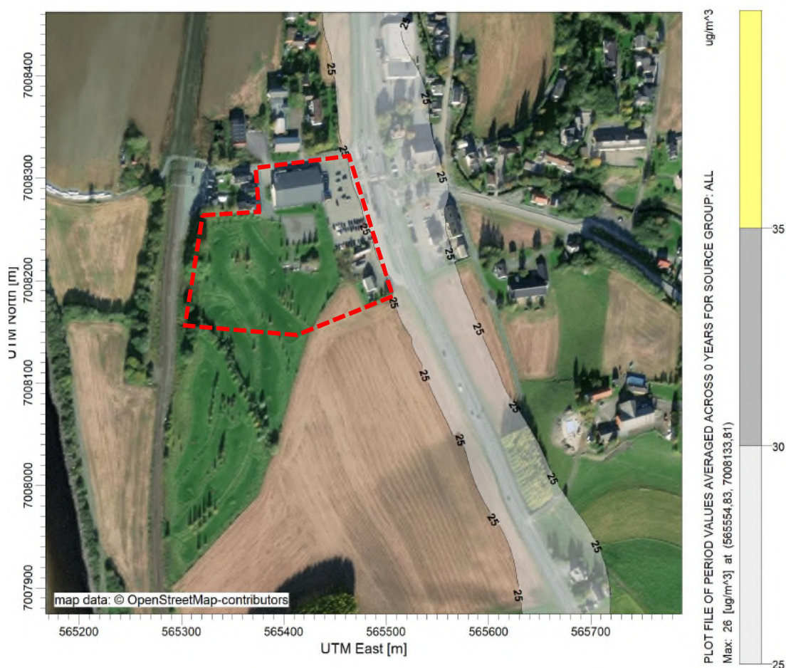
Figur 7: Luftsonekart som viser vintermiddel konsentrasjonen av NO 2 . Luftsonekartet viser at grenseverdien satt for NO 2 i Retningslinjen T-1520 overholdes på og rundt planområdet. Planområdet er markert med rød stiplet linje.
