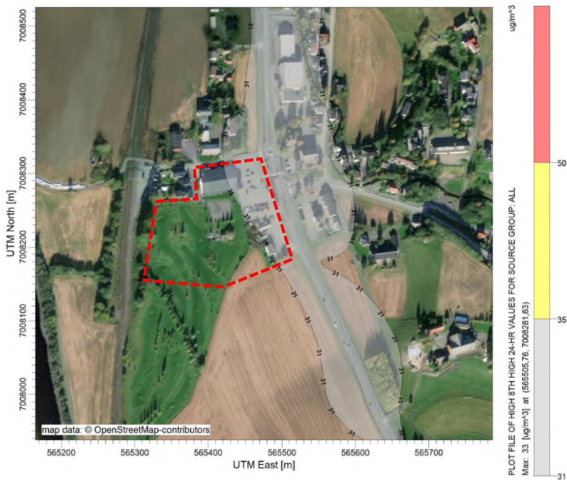
Figur 11: Luftsonkart som viser 8. høyeste døgnmiddel av PM10, som definerer gul og rød sone etter Retningslinjen T-1520. Luftsonekartet viser at begge grenseverdiene overholdes. Planområdet er markert med rød stiplet linje.
