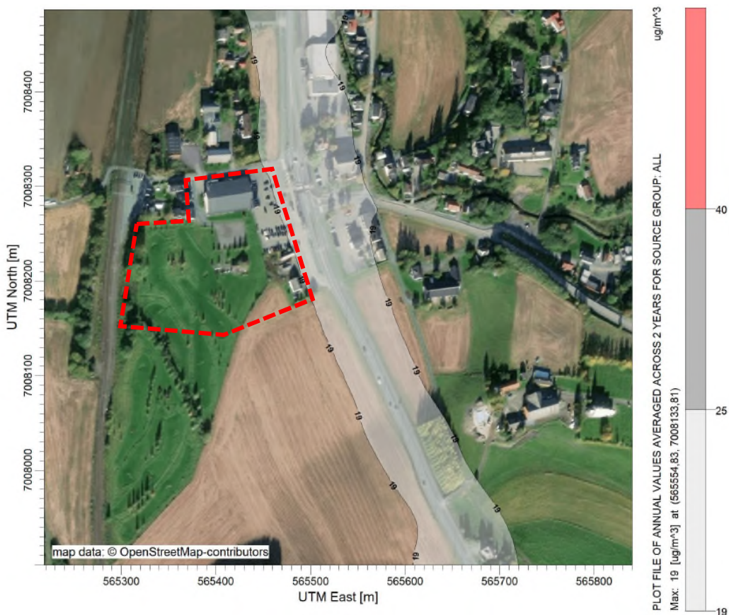
Figur 4: Luftsonkart som viser årsmiddel for NO 2 . Luftsonkartet viser at grenseverdien satt for NO 2 i Forurensningsforskriften, Retningslinje T-1520 og Miljødirektoratets og FHIs anbefalte luftkvalitetskriterier overholdes på og rundt planområdet. Planområdet er markert med rød stiplet linje.
