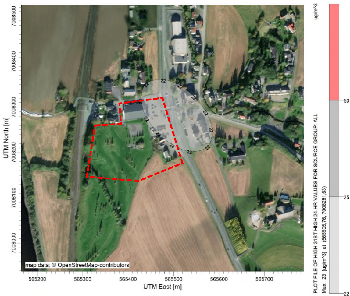
Figur 10: Luftsonkart som viser 31. høyeste døgnmiddelkonsentrasjon av PM10. Luftsonkartet viser at grenseverdien satt for PM10 satt i Forurensningsforskriften overholdes på og rundt planområdet. Planområdet er markert med rød stiptet linje.
